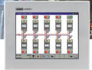
Отображение технологического процесса: индикаторное устройство резервуара
